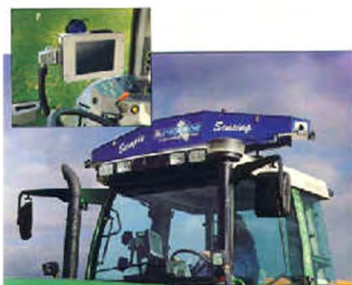
Sensor de nitrógeno montado sobre la cabina del tractor. Detalle de la consola
