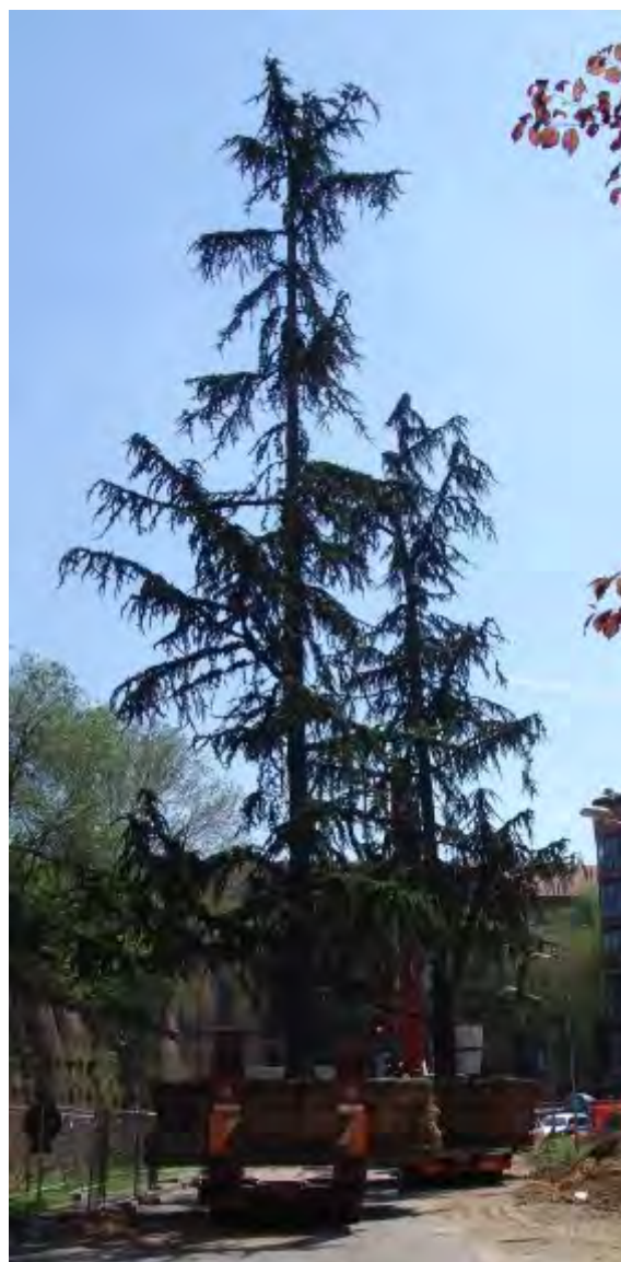
Transporte de dos cedros de 50 toneladas y 24 metros de altura, preparados mediante el sistema Transplat ®. Las limitaciones del transporte no está en los árboles sino en los obstáculos del entorno.
